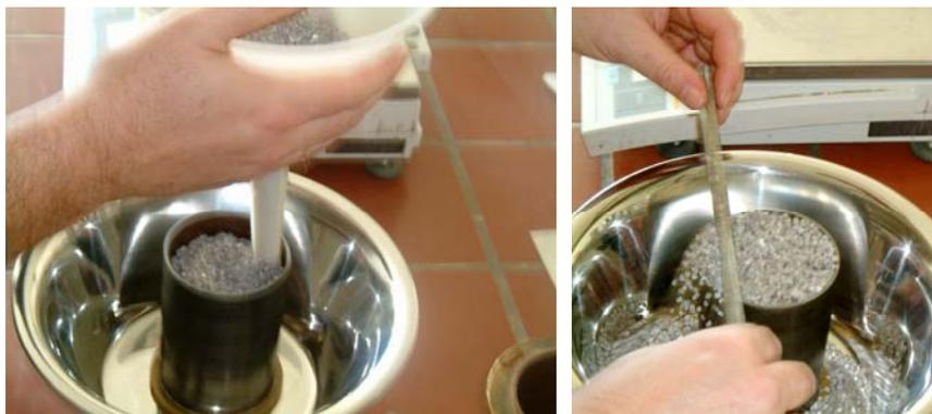
**Bild 18** Untersuchung der Porenanteils für die partikelspezifisch lockere Lagerung gemäß DIN 18126 „trocken“
