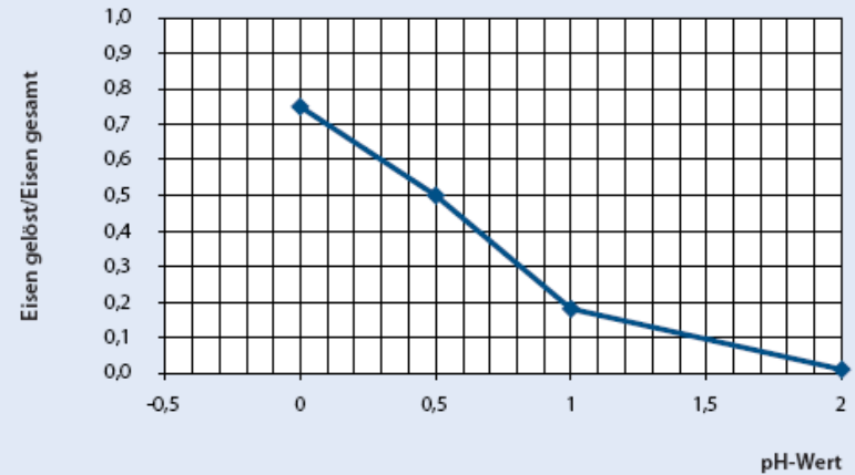
Abb. 7 Auswertung Tabelle 1: Eisenlöslichkeit in Abhängigkeit vom pH-Wert; Reg.mittel HCl
